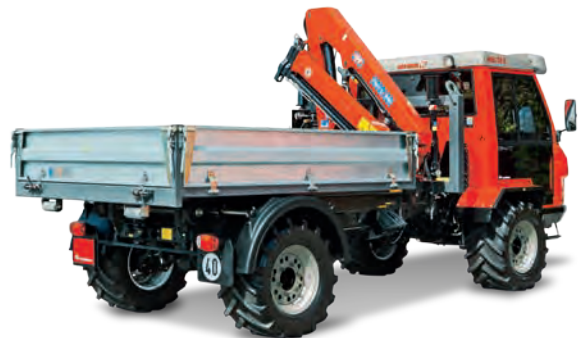
Transporter mit Kipper und Ladekran
