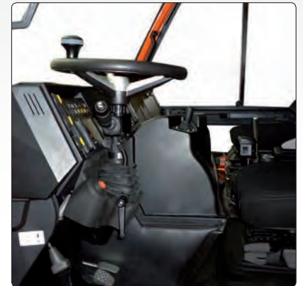
Höhen- u. neigungsverstellbare Lenksäule (Option bei Muli T6 - T8 S)
